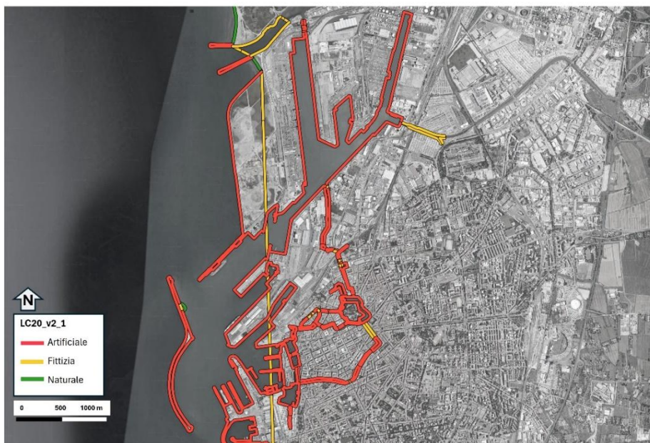
Figura 203. Estrapolazione di un tratto della linea di costa “LC20” di ISPRA in prossimità del porto di Livorno. In rosso è rappresentata la linea artificiale, in giallo la fittizia, in verde la naturale
