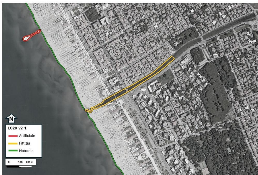
Figura 205. Estrapolazione di un tratto della linea di costa “LC20” di ISPRA in prossimità di un canale a Viareggio. In rosso è rappresentata la linea artificiale, in giallo la fittizia, in verde la naturale
