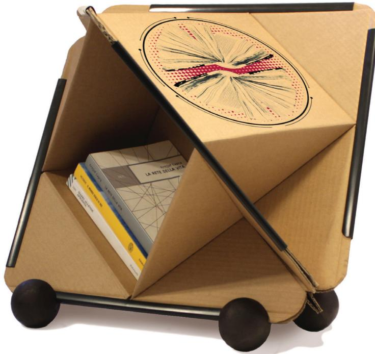
Il Box Libri è in cartone ondulato da tre millimetri di spessore, per conferire resistenza alla struttura si sono utilizzate otto bacchette in alluminio che proteggono dagli urti il bordo del cartone. I materiali sono stati scelti per garantire un basso impatto ambientale.
